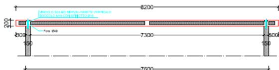
Le pareti dei manufatti sono internamente ed esternamente trattate con intonaco murale plastico. Il solaio di copertura, a doppia falda, è impermeabilizzato con guaina bituminosa in poliestere applicata a caldo, tipo ardesiata grigia.
